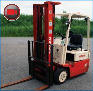
NISSAN 2.400 LB CAPACITY ELECTRIC FORKLIFT. MODEL 30
